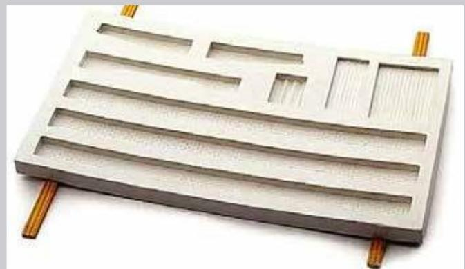
**TIPP Bahnsteig im Bogen:** Nach dem Abstreifen der Rückseite ist der Gips noch weich – läuft aber nicht mehr weg. Jetzt können Sie Abstandshölzchen unter die Form schieben. Ausrundung vorher „trocken“ ausprobieren. Evtl. dazu eine Schablone anfertigen und Modellzwingen verwenden.
